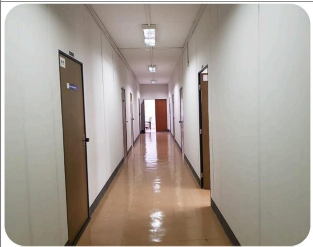
FOTO 01: Em destaque na foto o corredor do prédio de Professores do DEA/DETA após a reforma. A reforma compreendeu a alteração de layout de várias salas, com instalação de divisórias acústicas, para atender a demanda pedagógica atual. Também foi executado pintura e foi reformada toda a infraestrutura elétrica e de dados.
