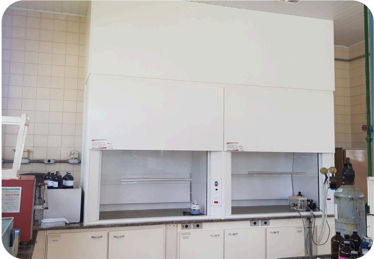
**FOTOS 1:** Em destaque na imagem a capela dupla instalada no Laboratório de Óleos e Gordura. O equipamento é compatível com análise que utilizam ácido.
