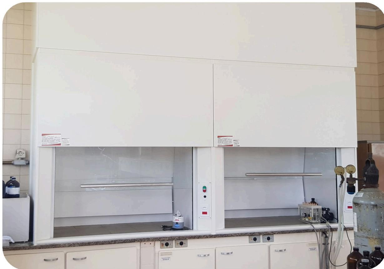
**FOTOS 2:** Em destaque na imagem a capela dupla instalada no Laboratório de Óleos e Gordura. O equipamento é compatível com análise que utilizam ácido.
